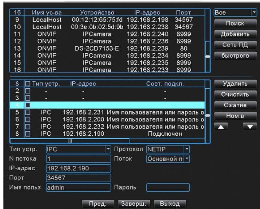
Рис. 1.1.5. Ручной режим настройки камер для облачного сервиса
