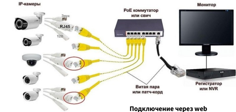
СТАНДАРТНАЯ СХЕМА ПОДКЛЮЧЕНИЯ IP-КАМЕР К РЕГИСТРАТОРУ
