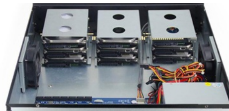
Рисунок - пример размещения жестких дисков в корпусе регистратора
