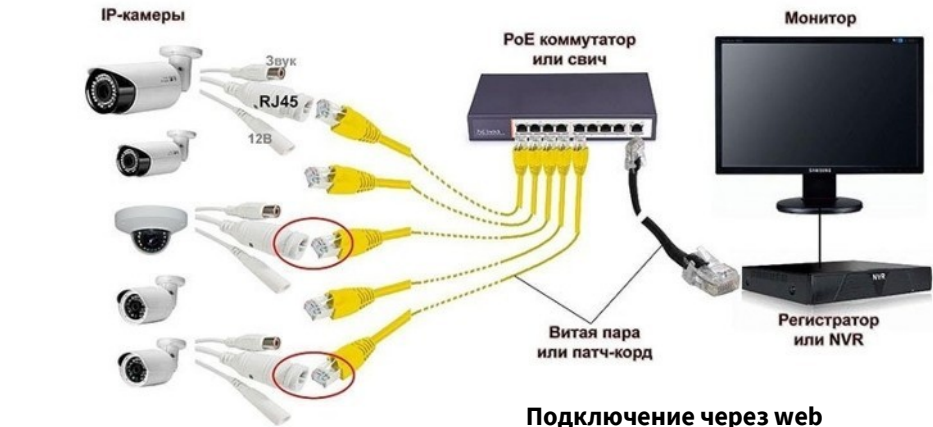
СТАНДАРТНАЯ СХЕМА ПОДКЛЮЧЕНИЯ IP-КАМЕР К РЕГИСТРАТОРУ
