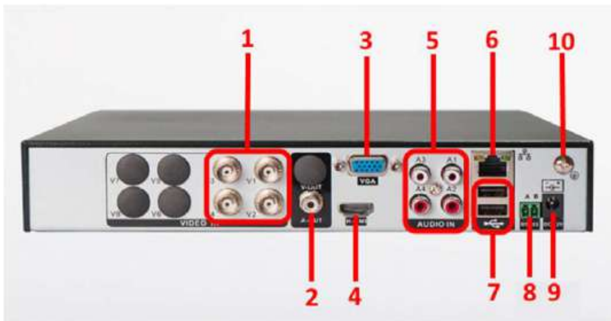
Рис.1.1.1. Задняя панель регистратора (Пример)
