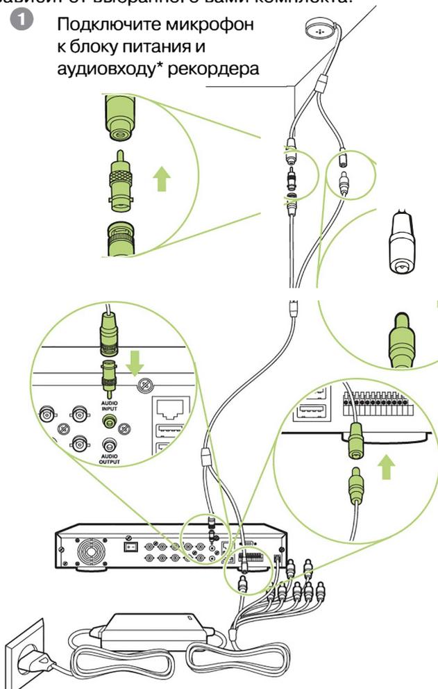
\* Для подключения микрофона используйте переходники BNC/RCA (в комплекте).
